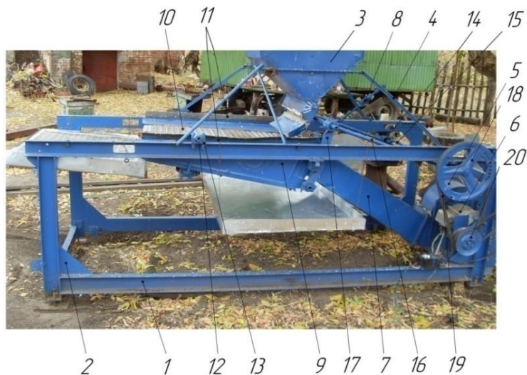
Рисунок 21 – Лабораторная установка для определения содержания сорных примесей в проходе и маслосемян в сходе с решета: 1 – рама; 2 – косянки; 3 – бункер; 4 – подставка; 5 – вентилятор; 6 – электродвигатели; 7 – воздуховод; 8 – стяжка; 9 – лоток; 10 – решето с регулируемыми отверстиями; 11 – направляющие лотка; 12 – оси; 13 – шарниры; 14 – кривошипно-шатунный механизм; 15 – кривошип; 16, 17 – рычаги; 18 – шкив; 19 – ремённая передача; 20 – шкив
