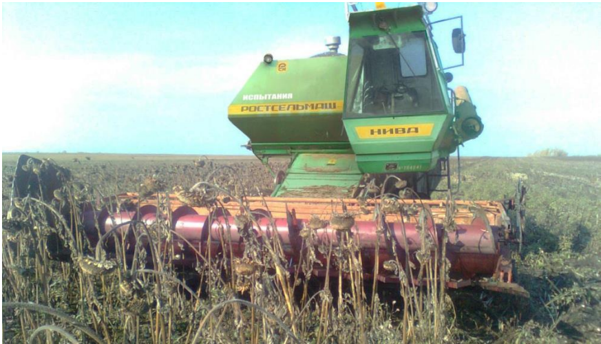
Рисунок 27 – Производственные испытания шнека-мотовила
